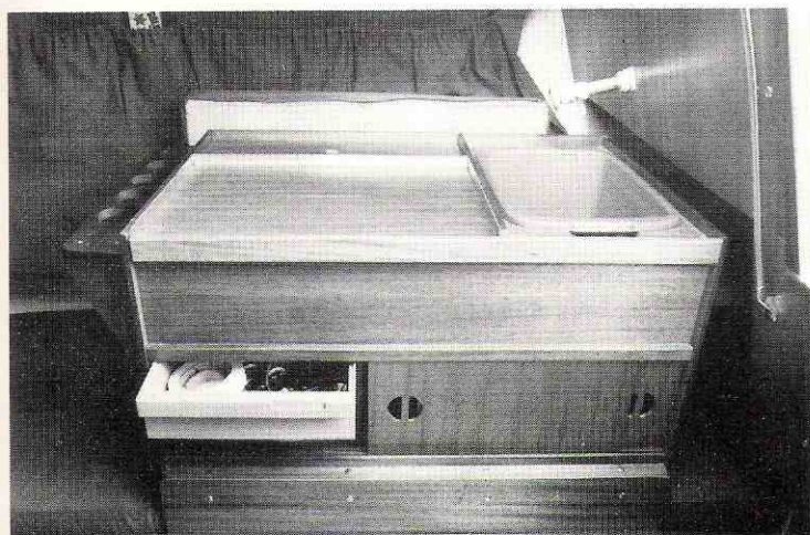
Ein Kartentisch, wie er sein soll. Unterwärts Fächer und Schubladen für Gerätschaften.
