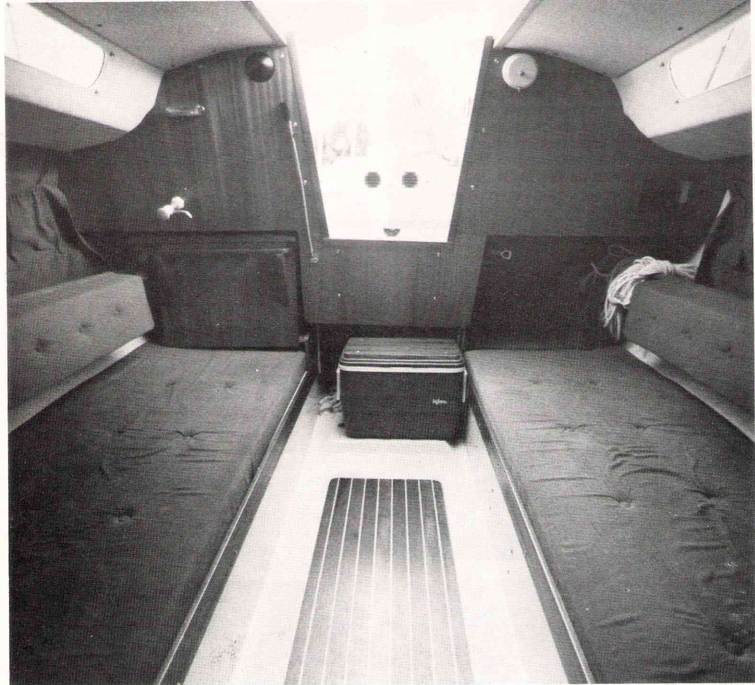
Die tragbare Eisbox (Bildmitte) ist trittfest und dient deshalb als Einstiegstufe. Backbordseitig eine Hundekoje. Eine entsprechende Koje ergibt sich, wenn man steuerbord die Pantry wegnimmt.
