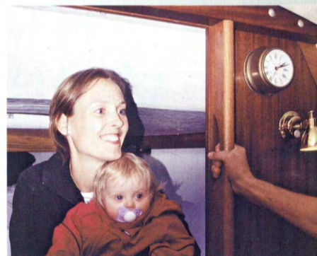
Karmene i åbningen mod forkahyt har praktisk håndgreb. Karmene bærer en vandret bjælke og dermed masten.
