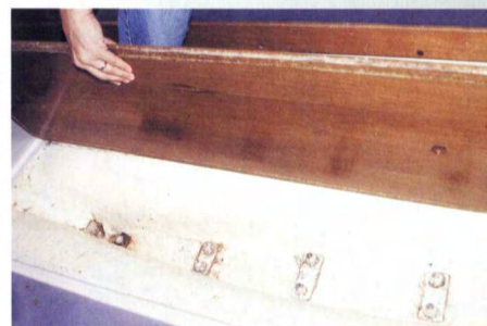
Bravo, skrå bund i kølsvinet, så vand løber til lænsepumpen agter. Moderne både har ofte vandret bund, så vand ikke løber væk.
